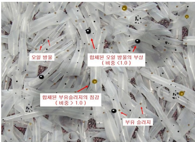
<U.H.M.W FILTER의 오염물질 처리 모식도>
